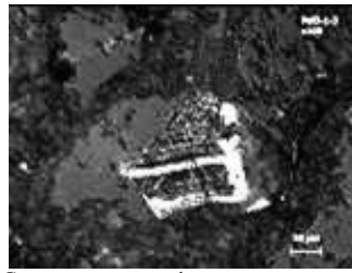
Структура гетерофазного окисления титаномагнетита
